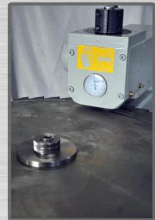
Contrôle de mise en tension par jauge
