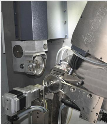
Exclusion automatique des dents cassées et indexation de pas variable grâce au doigt poussoir intelligent. Système pneumatique optionnel pour inciseurs extensibles (en deux parties).
