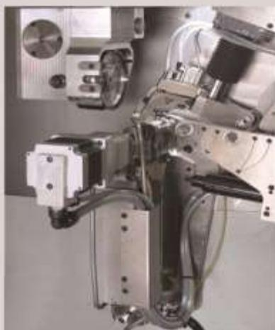
Couple, distance et contrôle d'épaisseur de lame automatique par serrage pas à pas
