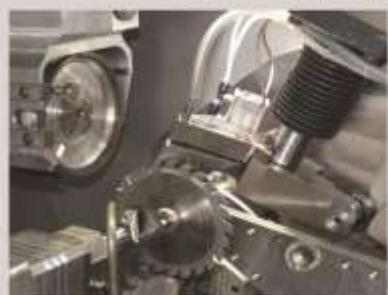
Exclusion automatique des dents cassées et indexation de pas variable grâce au doigt poussoir intelligent. Système pneumatique optionnel pour inciseurs extensibles (en deux parties).
