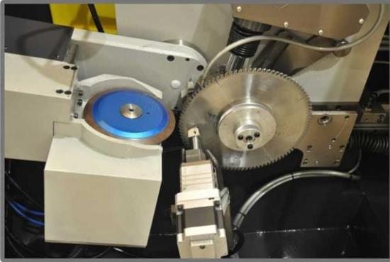
Saute automatique des dents cassées et indexation de pas variable par doigts intelligents. Système pneumatique pour meulage de lame double face en un cycle.
