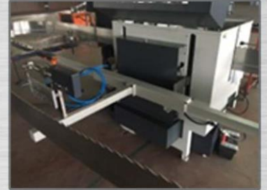
Kabin dışında testere kaldırma sistemi ve yardımcı tırnak itme sistemi (Pnömatik)
