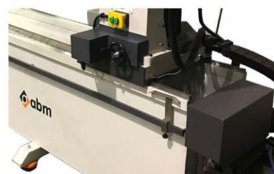
Opcional de inclinación automática para cama magnética Opcional de avance automático por controle de motor
