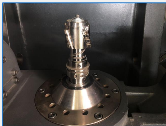
HSK - A63 Держатель инструмента
