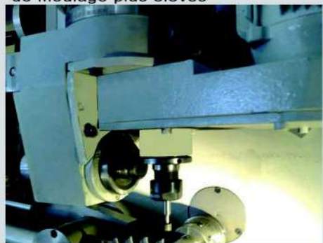
Accessoire de meulage pour les faces creuses de lames de scies circulaires Optionnel
