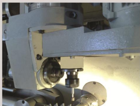
Opcional de diente cóncavo para el afilado inferior cóncavo de sierras circulares.
