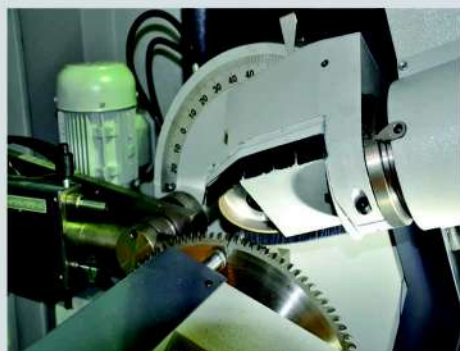
Construction ABM adaptée aux opérateurs pour une utilisation facile Système de roulement pour des résultats de meulage plus élevés
