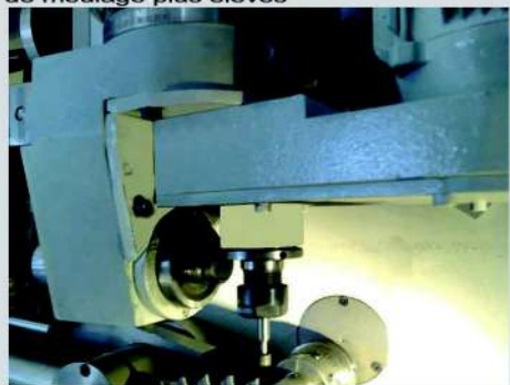
Accessoire Optionel de meulage pour les faces creuses de lames de scies circulaires.
