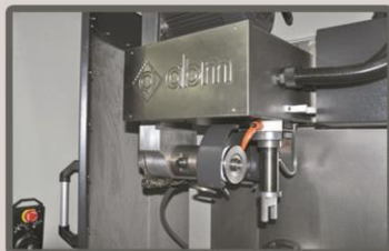
* Système de mesure laser optionnel (calcul automatique du diamètre de fraise-scie et du nombre de dents)
