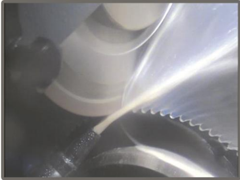
Affûtage d'une fraise-scie HSS avec meule CBN Ø 200mm
