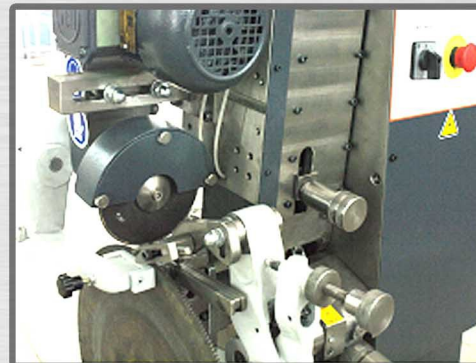
Chanfreinage manuel a droit / a gauche de lame de scie circulaire HSS
