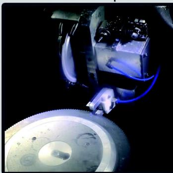
système de mesure par laser interne pour le comptage des dents et le réglage automatique
