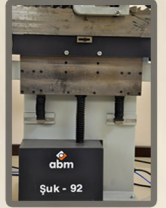
Motor yardımlı şerit testere aşağı-yukarı hareketi.
