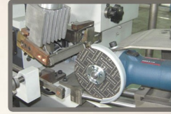
Kesme motoruyla manuel olarak kesilen stellite çubuk.
