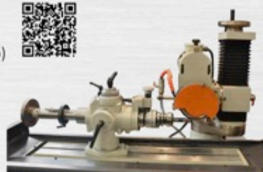
Strumento dell'affilamento degli utensili elicoidali
