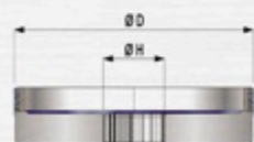
Mola dell'affilamento dorso Tipo: 6AA9 D: Ø 80-125 mm d: Ø 20 mm
